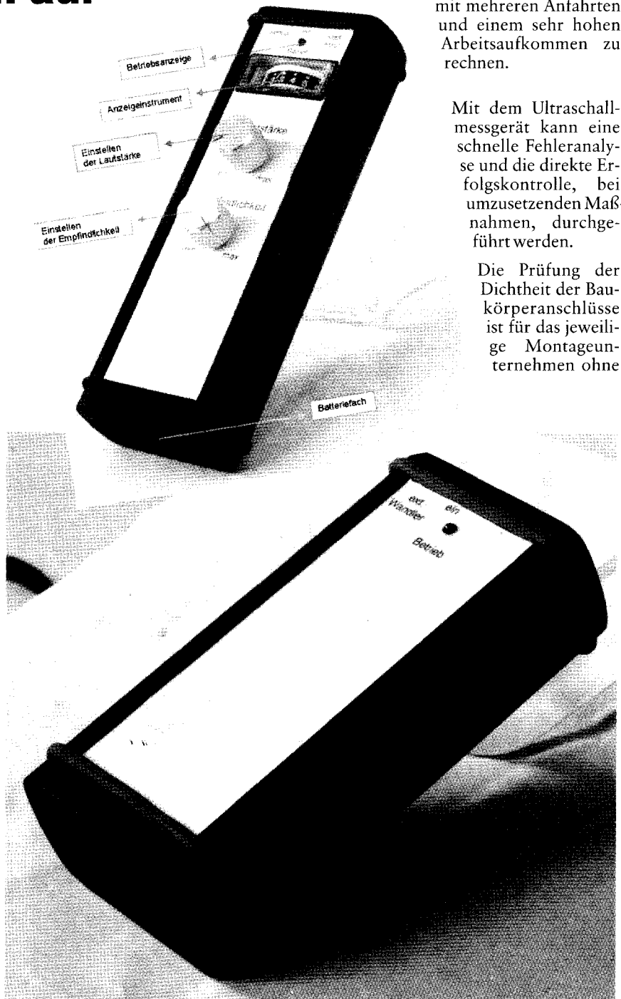
Mit dem Ultraschall-Detektor der FCSM GmbH, Menden, lassen sich jetzt undichte Stellen an Fenstern, Fassaden und Wintergärten schnell und unproblematisch aufspüren. Im Bild Sender und Empfänger.
